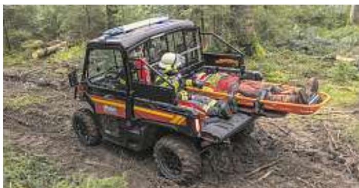
*Das Fahrzeug kann bei Bedarf mit einer Schleifkorbtrage ausgestattet werden, um verletzte Personen sicher transportieren zu können.*
